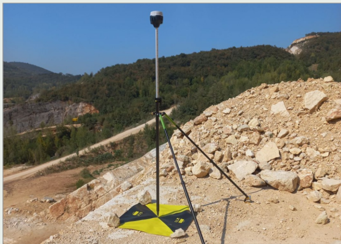
Foto 7. Posizionamento sul terreno di target ad alta visibilità (Ground Control Point) e rilievo degli stessi tramite sistema GNSS topografico - Foto M. Tremari
