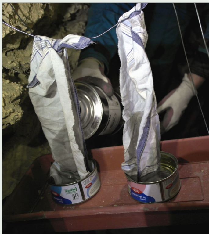
Foto 6. Tracciamento qualitativo con D-Limonene (Abisso Nueva Vida, Sebino Occidentale, BG): la stazione di rilascio - Foto M. Miragoli
