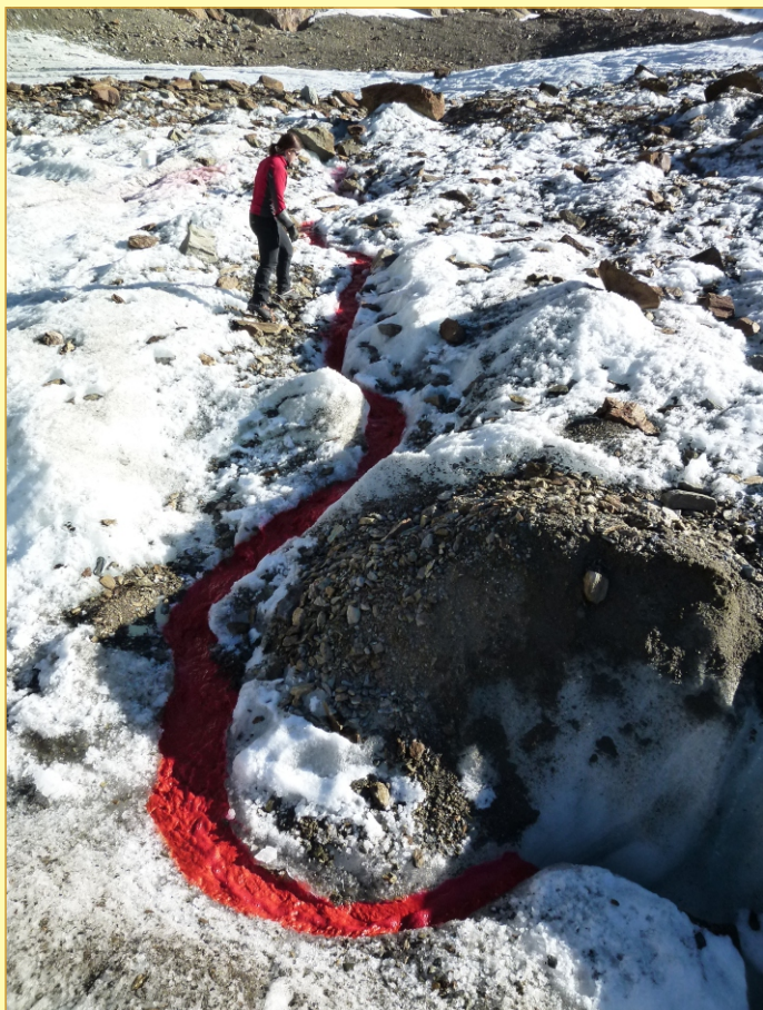
Foto 4. Ghiacciaio dei Forni: punto di immissione del tracciante (Aminorodamina) - Foto S. Franchi
