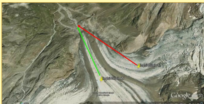
Figura 6. Punti di immissione al Ghiacciaio dei Forni (in verde Fluoresceina, in rosso Aminorodamina): attualmente i tre bacini confluenti sono completamente separati
