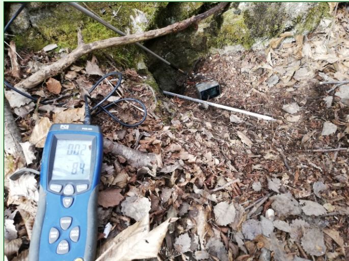
Foto 10. Misurazione velocità del flusso presso l'imbocco di una cavità che inverte l'alitazione a intervalli regolari (Invertita). Viene utilizzato anemometro portatile «a filo caldo», termometro a mercurio tarato a decimo di grado e videocamera per la registrazione viva con candele delle inversioni - Foto: V. Franchini
